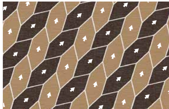
Verlegen von Prismen in zwei Farbtönen.
