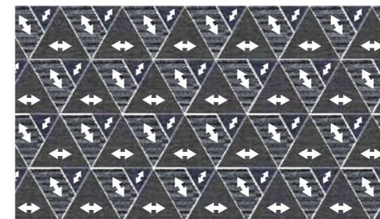
Verlegen von Dreiecken und Halb-Sechsecken nur einer Farbe.
