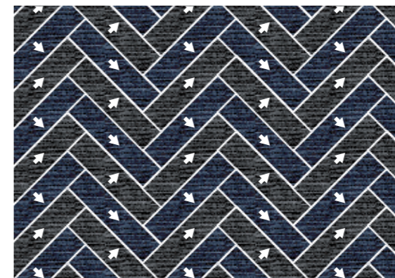
Verlegen im Fischgrätmuster in einem Farbtönen mit quer und längs zugeschnittenen Dielen.
