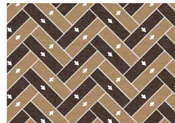
Verlegen im doppelten Fischgrätmuster in zwei Farbtönen.
