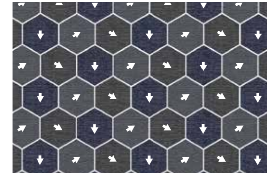
Verlegen von sechseckigen Fliesen einer Farbe.
